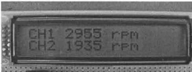
図6.1 フィルタ機能によるLCDへの表示
