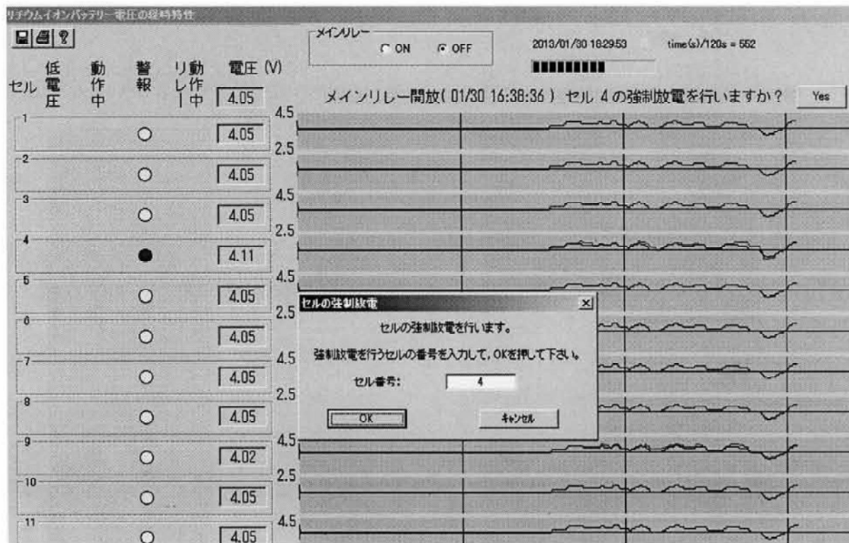
図 7.2 机上システムにおけるセル電圧の経時特性の測定例
