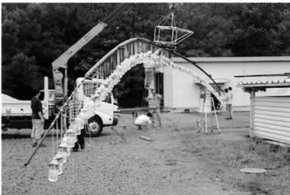
図-13 主桁の分布荷重試験で強度を確認する
