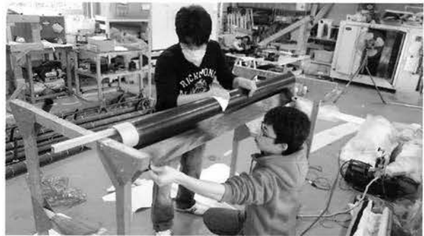
図-11 カーボン繊維は手巻きで積層成型している
