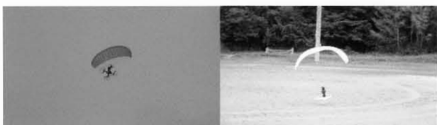
図-27：滑空状態 → 360度旋回し着陸態勢へ → 指定点に着陸 実測の結果、滑空比は3以上確保できた。また、滑空中
