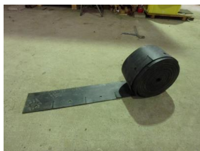
Fig.7 路面簡易排水帯
