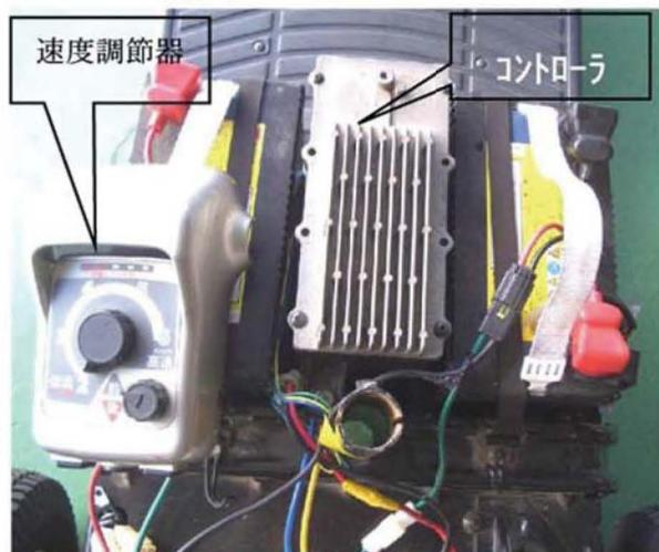
図7 車体に組み込んだコントローラ
