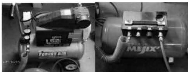
図6 小型圧縮機 図7 空気タンク
